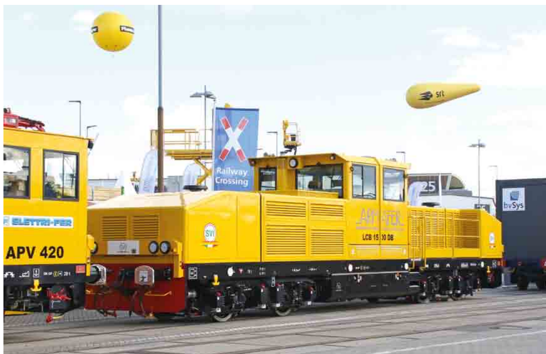
Den italienske producent SVI S.p.a. fremviste dette kraftige rangerlokomotiv Armafer LCB 1500 DB til brug ved anlægsarbejder. SVI er et forholdsvis ny firma, som blev grundlagt i 1999 og er hjemmehørende i Lucignano i det centrale Italien. Virksomheden bygger specialkøretøjer til konstruktion og vedligeholdelse af jernbaneinfrastruktur.
