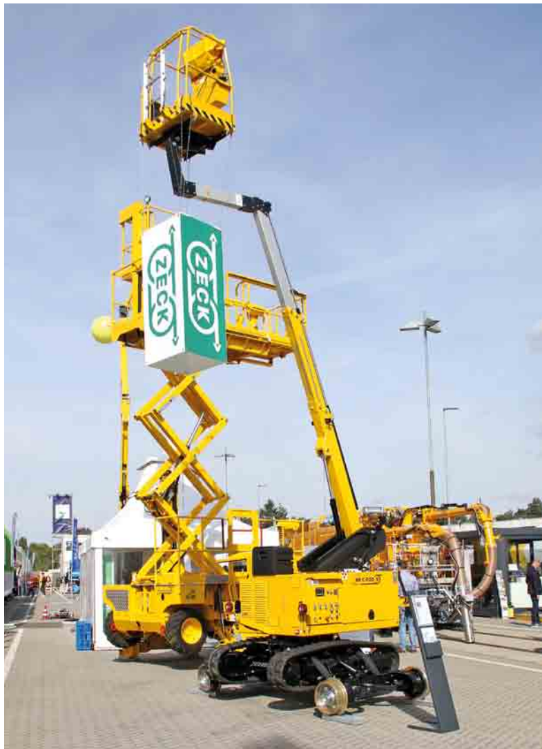
To af ZECK's lifte til brug ved køreledningsarbejder, RR LAMA DR HEV og RR C-POD 9.
