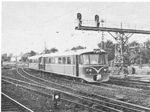
LNJ's første Y-togsæt passerer Hellerup station (17/6) på vej fra Rødby Færge til Gentofte (Jægersborg). Bemærk »kaninørerne« over dørene – lysskilte, der kan vise »Indstigning« eller »Ingen indstigning«. Foto: E. B. Jonsen.
