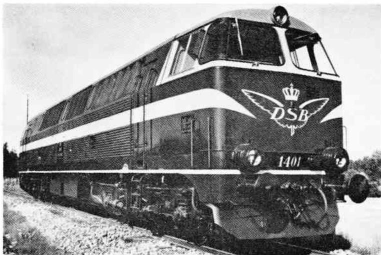
Det första av 25 NOHAB GM-dieselelektriska 3300 HP-lokomotiv för Danmark med GM's nya överladdade 16-cyl. dieselmotor, växlat för 143 km/h.
