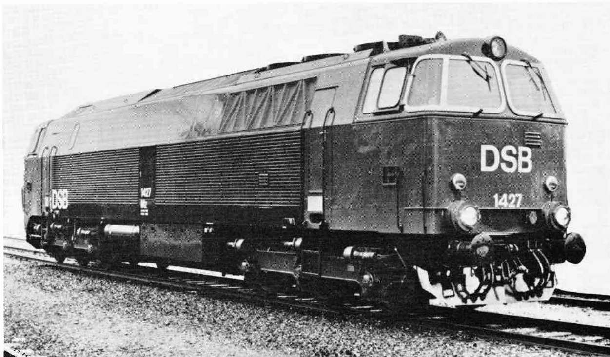
Dieselettrisk motorlokomotiv, litra Mz (3. serie). Bemærk den højere »tagrejsning« (indeholder det forstærkede lyd-dæmpningsudstyr), de kraftigere aluminiums-vindueskantlister og de indbyggede slutsignaler. Mz 1427 ankom til København, den 5. december – 1428, den 9. januar. (Udførlig teknisk beskrivelse af afdelingsingeniør A. Bondesen bragtes i »DSB-bladet kommunikation«, nr. 12/72).
