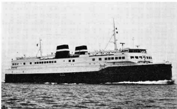
M/F »Romsø«, der den 2. marts 1973 indsattes på Halsskov–Knudshoved overfarten. Færgen kan overføre 440 biler og 1500 passagerer pr. tur. Foto: DSB, Steenwijk
