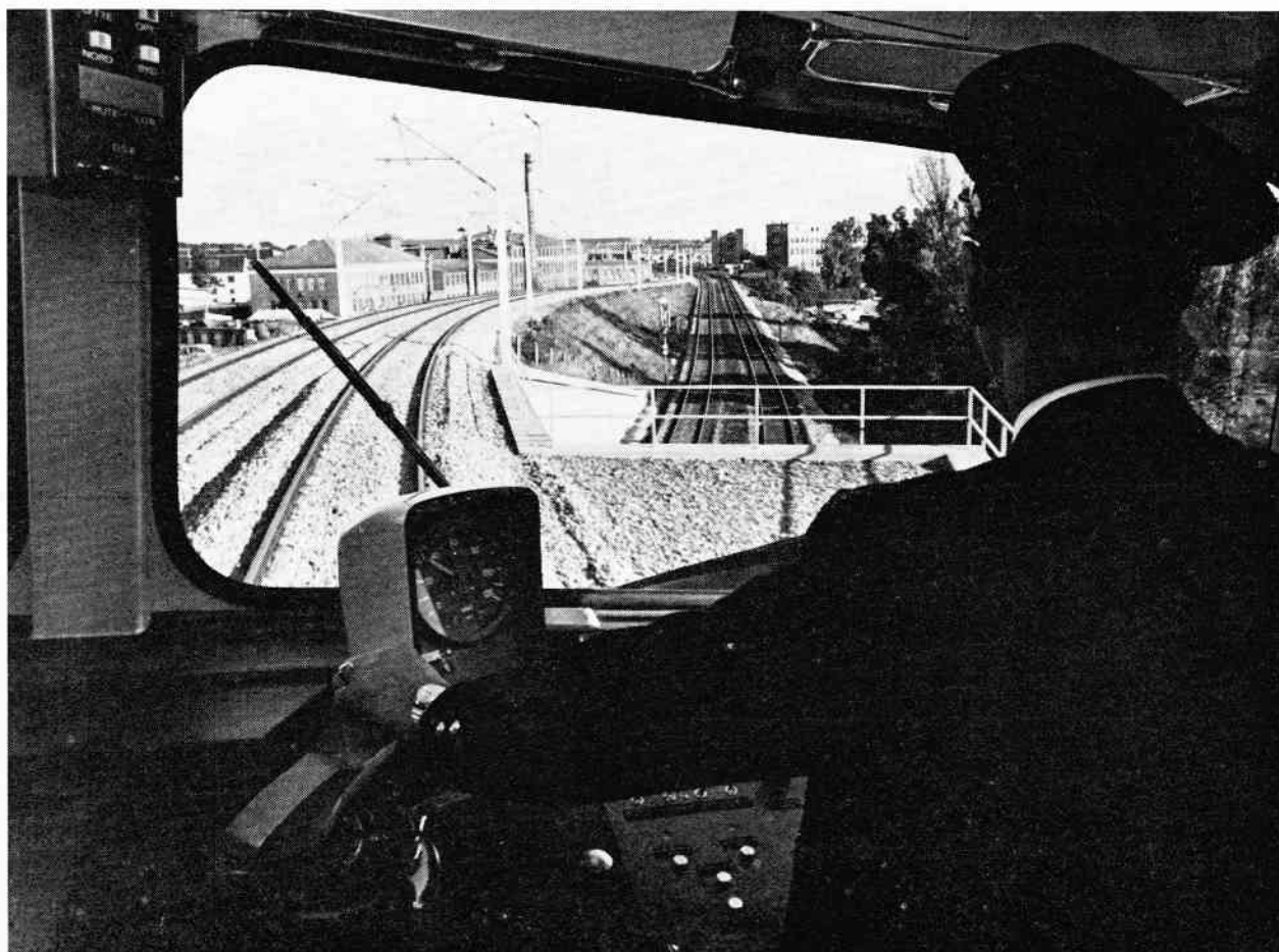
Fig. 2. Interior af førerrum i S-tog af ny type. Ved førerens venstre hånd ses HKT-hastighedsviseren – øverst til venstre ses betjeningspanelet for radio. (Tog på Køgebugtbanen under passage af Godsforbindelsesbanen – køreretning: Ellebjerg-Sjælør). Foto: Peter Præstrud.
