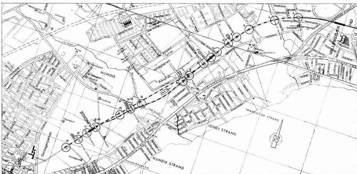
Køgebugtbanens forlængelse fra Vallensbæk (km 14,7) til Hundige (km 19,2). Cirkler og numre angiver placering af de enkelte under- og overføringsanlæg, tunneler m. v. – se i øvrigt tekstafsnittet. Tegning: DSB/Baneafdelingen/AnIn.
