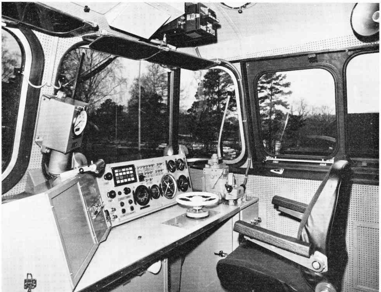
Førerpladsen med den nye type førerstol. På panelet længst til venstre er reserveret plads til betjeningsudstyr for ITC og elektrisk togvarme. Til højre derfor er køreplansholderen anbragt (på billedet er den klappet ind – den kan trækkes ud til magnetlåsen midt på bordplanen).
