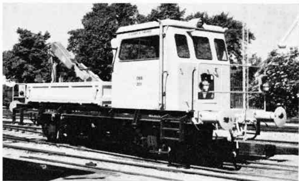
Baneafdelingen har fået en ny og større type motortrolje – foreløbigt fem stykker. Troljerne (nr. 201–205) er leveret fra det østrigske firma »Plasser & Theurer«; Type OBW 10 – motor: »Deutz« (type F 8 L 413) 192 HK. Transmissionen er diesel-hydraulisk. Foto: Tom Lauritsen.
