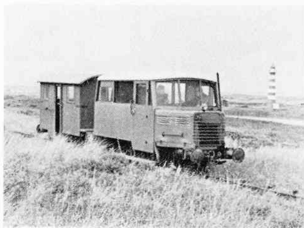
»Persontog« på Vandbygningsvæsenets bane ved fyret på Aggertangen. Inspektionsmotorvognen var oprindelig bygget til normalspor. August 1973. Foto: Ole-Chr. M. Plum
