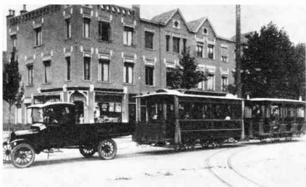
Tractortram til Eelde i Groningen 1924. Bemærk skiltet på lastvognens tag og bremsestangen mellem bilen og bivognene.
