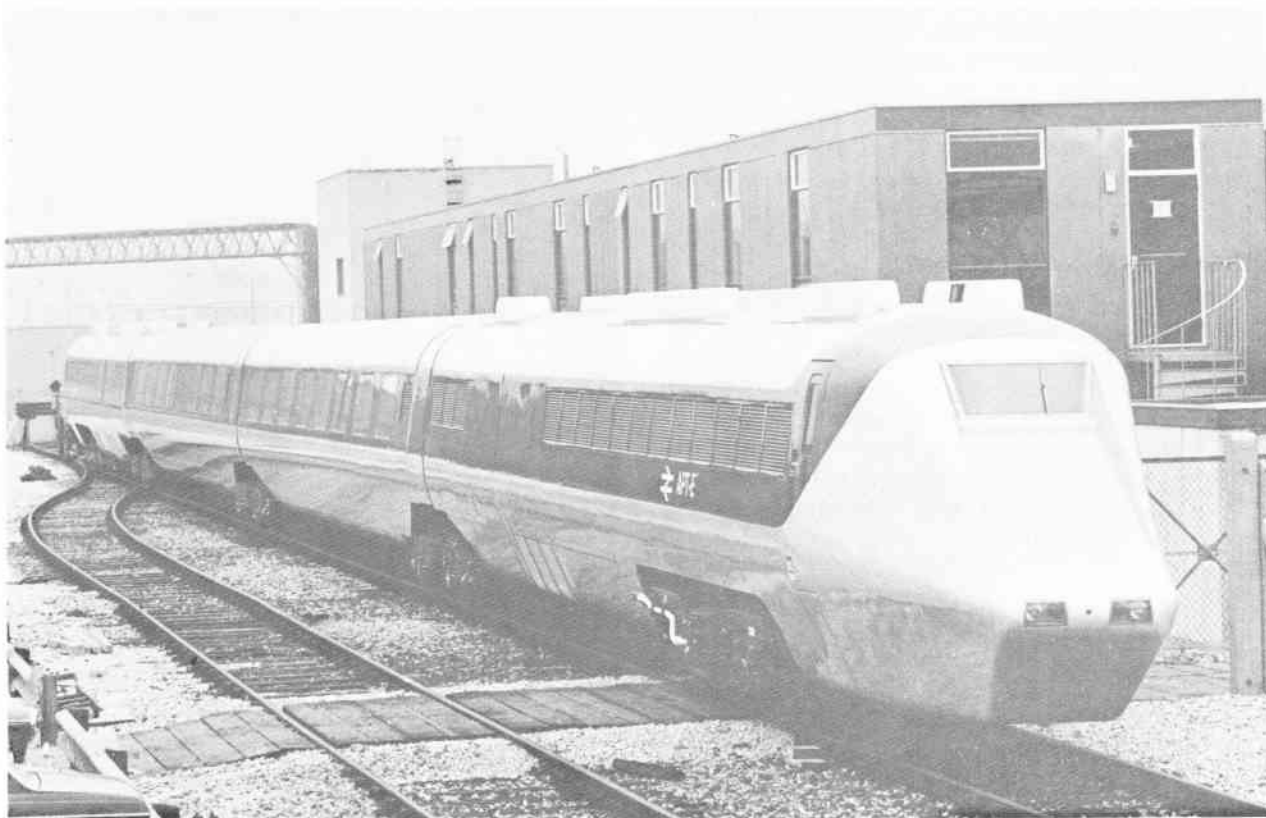
British Railways' første APT-tog, frugten af ti års intensiv forskning, er konstrueret til at køre 250 km/t på det eksisterende spornet og med den nuværende form for signalanlæg.
