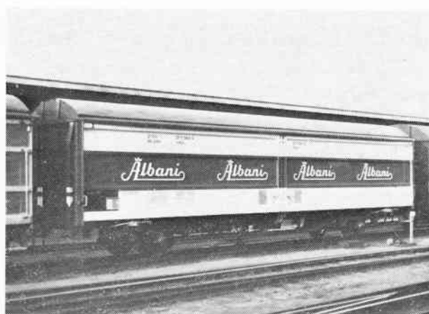
Tre Hbis-vogne (211 5, 562, 564, 566) er stillet til rådighed for „Albani Bryggerierne A/S“ og malet i denne virksomheds „husfarver“. Vognene vil i øvrigt blive omlitret til Hbis-t, da de skal udstyres med luftbølge for lastbeskyttelse. Foto: K. E. Jørgensen
