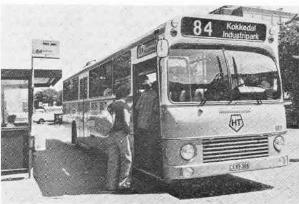
HT's nye nærtrafikbustype (serie VN), hvoraf ca. 25 var leverede pr. 1. oktober, har dobbelt dør både foran og i midten, særlig dørsikringsautomatik, store skilte udvendigt og desuden indvendig linienummerskilt. Busserne har større loftshøjde end tidligere, og ventilationsdyser over stolene. Desuden er busserne forsynet med en særlig elektrisk bremse, en såkaldt „retarder“, og såvel det udvendige som indvendige støjniveau er reduceret. Foto: HT
