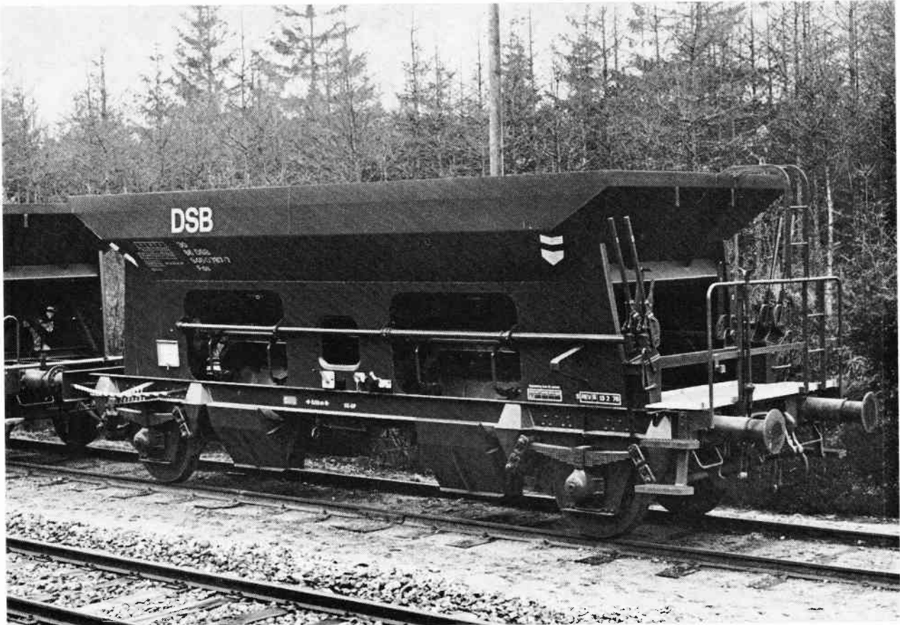
Fds-vogn - af serien 946 0 750 - 946 0 879 - bemærk den afvigende konstruktion i forhold til de tidligere leverede selvtømmende ballastvogne, litra Fd. Fds-vognene er sortmalede. Foto: Ole Kien.
