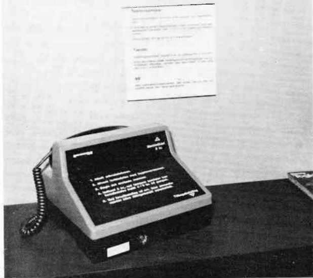
Radiotelefon-betjeningspanelet hos togstewardessen i BMk-vognen (øverst) og monttelefonen i samtaleboksen (nederst). Foto: N. E. Jensen.
