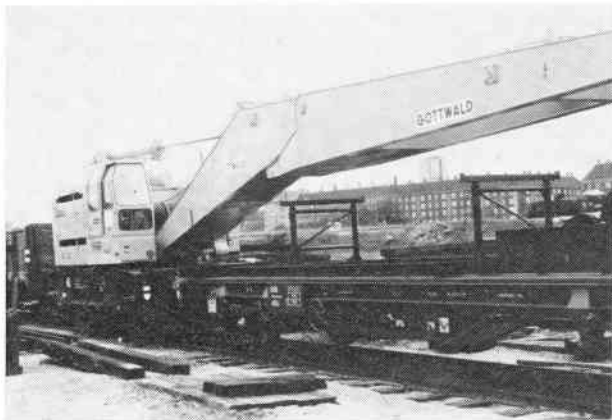
Baneafdelingen har modtaget den første af to nye sporlægningskraner (med lofteevne 25 t): Tjenestevogn nr. 158, leveret fra firma »Gottwald« i Düsseldorf med tilhørende løber: Tjenestevogn nr. 450, leveret af »Scandia-Randers A/S«. Foto: K. E. Jørgensen.
