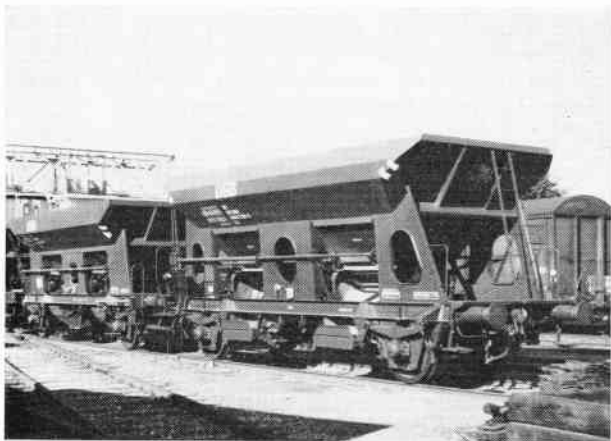
Ballastvogne til brug ved Baneafdelingens og Banetjenestens anlægs- og vedligeholdelsesarbejder - litra Fd (t.h.) og litra Fds (t.v.). Samtlige 130 stk. litra Fds er nu afgivet til drift. Foto: K. E. Jørgensen.
