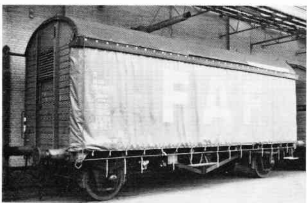
De seks Gkln-vogne, der er stillet til rådighed for »Fyns Andelsfoderstofforretning«, hvor den ene vognside er erstattet af en pressening, er omlitret til Hks-x (215 0 900 - 215 0 905).
