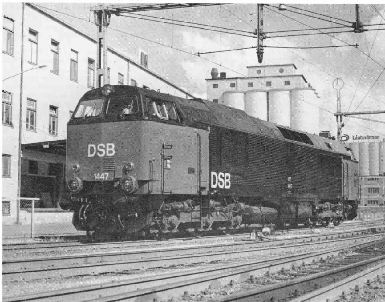
De to første MZ-lokomotiver (serie IV) afleveredes fra AB BOFORS-NOHAB, Trollhättan, lørdag den 2. juli. - MZ 1447 ses her på Helsingborg Färjestation. Miljømæssige krav har præget konstruktionen, der har bl. a. skullet skaffes plads til en mere effektiv lyddæmper - og det har lokomotivet næppe vundet ved i æstetisk henseende. Tekniske detaljer følger i næste nummer af tidsskriftet. Foto: Ole Kien.
