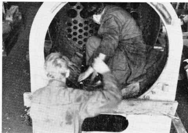
Valsningen i røgekammeret er blevet udført med forlængere til skrallen, således at trækket blev udenfor røgekammeret. Valsen til de små rør har en diameter på ca. 46 mm.
