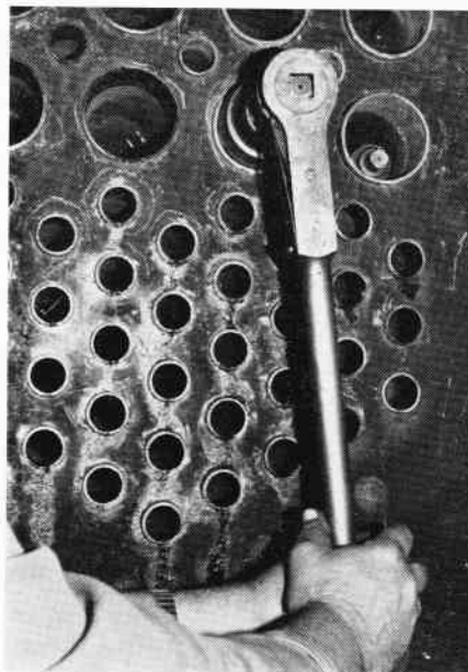
Valsning af overhederrør i fyrkassen foregår manuelt med en valse, hvis diameter er ca. 95 mm.
