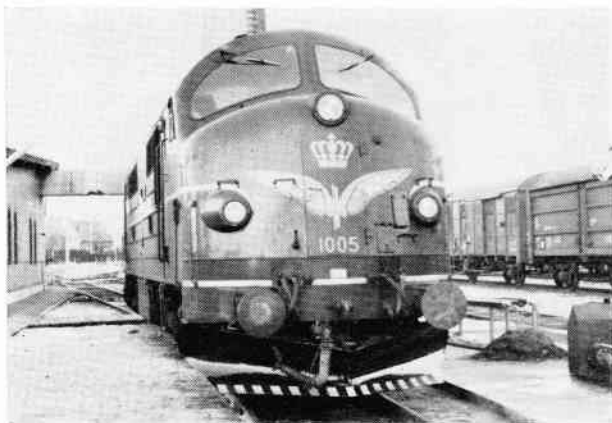
DSB's lokomotiver af litra MY og MX får nu monteret underhængte snepløve i begge ender af lokomotivet. Her ses DSB MX 1005 med underhængt pløv i Korsør, 24. november 1979. Foto: Jan Lundstrøm.
