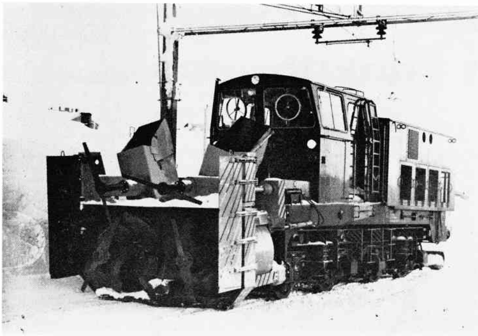
Den første anskaffede type sneslynge fra Beilhack rydder i normalt profil. Om sommeren afmonteres selve sneslyngen og resten af køretøjet benyttes som trolje. Foto: Thorkild Jensen.
