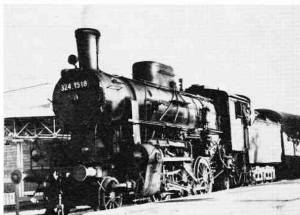
Type 324 med højtliggende Brotan-kedel, bygget 1920.
