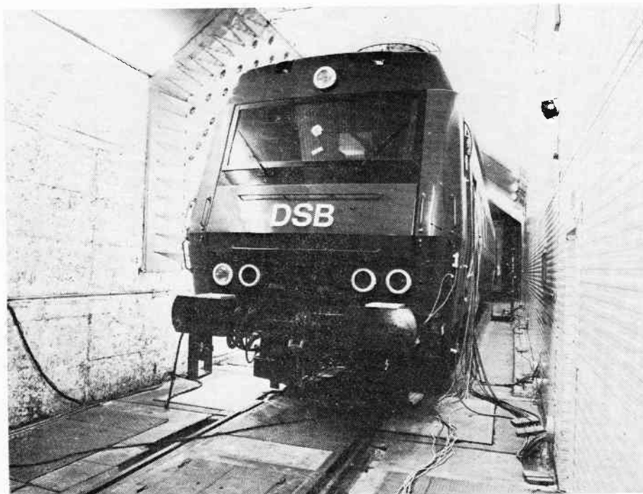
Det nye lyntog i klimakammeret i Wien Arsenal.
