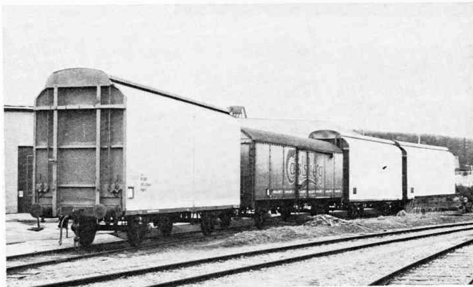
Bryggerierne er ved at udskifte deres vognpark. Den nye type ølvogne, litra Hios-v er delvist genbrug, idet undervognene stammer fra udrangerede godsvogne, litra Gs. Hios-v 42-86-230 7 084-7, gammel type ølvogn 20-86-083 5 269-5 samt to type Hios-v (036 og 047) med malede sider i Åbenrå 9. april 1982. Foto: Jan Lundstrøm.
