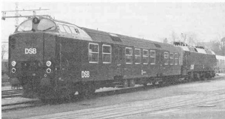
Ombygningen af styrevogne til brug for el-driften betyder endnu en variant i DSBs vognpark. Bns-e 545 holder sammenkoblet med EA 3004 i Helsingør den 22. december 1985. Foto: Jan Forslund
