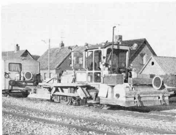
Ballastfordelingsmaskine Bf 6 er leveret af Sollinger Hütte, der har bygget maskinen på licens fra USA. Faxe Syd den 6. november 1982.
