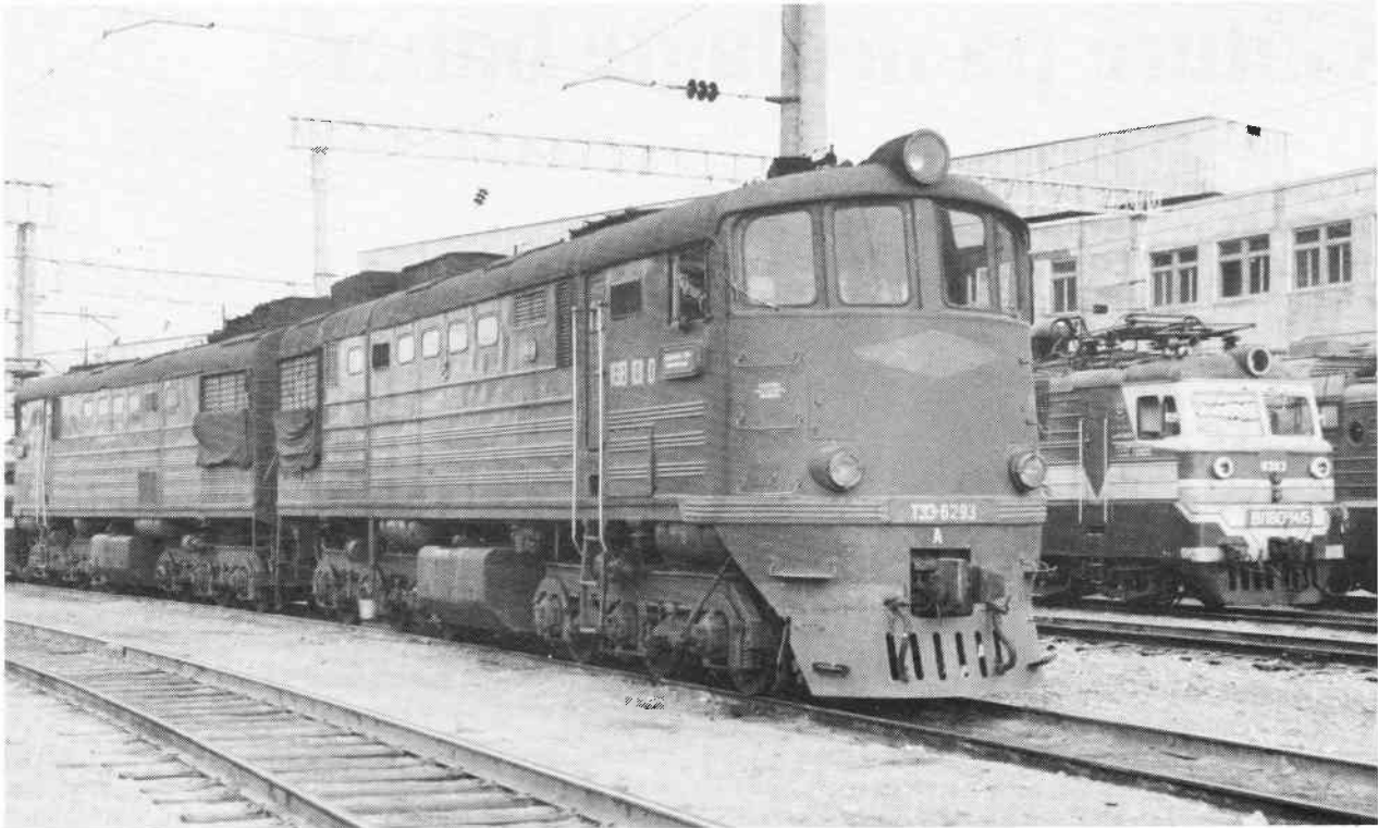
Ved lokomotivdepotet i Severobajkalsk anvendes til rangering et TE3 diesel. Det er en meget driftssikker Co'Co' + Co'Co' maskine med 2 x 2000 hk, og de anvendes meget til arbejdstog under anlægget af BAM
