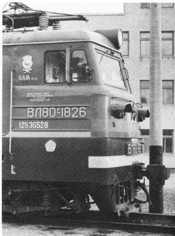
VL80R-lokomotiv med De sovjetiske Statsbaners våben, BAM-initialer, politisk citat om elektrificeringens betydning, det gamle lok-litra/nummer i metal og det nye, EDB-forberedte.
