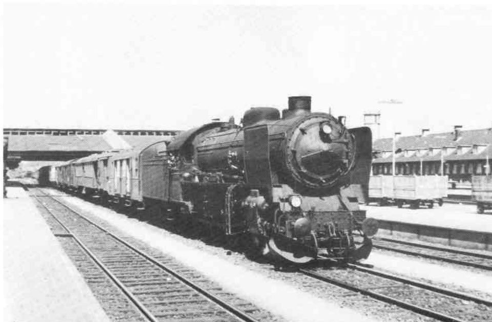
R 959, der fik en alderdom på Albani bryggerierne i Odense, ses her i spor 8 i Fredericia i juni 1964 med godstog. R 959 var en af de R-maskiner, som havde den besynderlige røggammerdør. En sådan havde 951 også, og R 963, der eksisterer endnu, har en lignende
