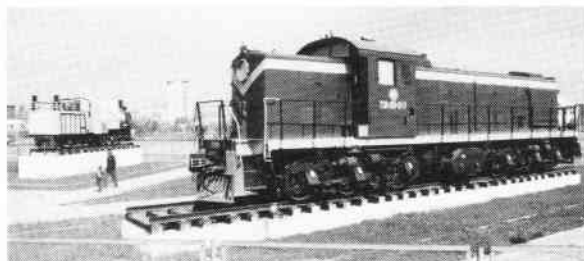
Mørkegrønt diesellok TE1 20-011 er af konstruktion et år ældre end TE2, men kom først til Mongoliet i 1956. Typen er det første seriebyggede sovjetiske diesellok og har kun 1000 hk. Typen anvendtes mest til rangering og i mindre godstog, og blev hos MTZ taget ud af drift i 1986.
