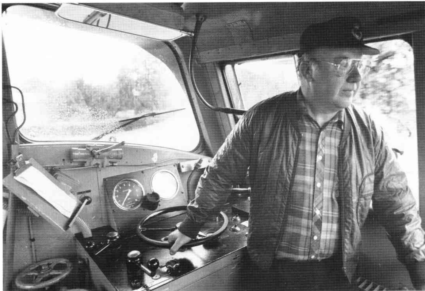
En arbejdsplads, der snart forsvinder - førerrummet på et MH-loko. Bemærk i billedets venstre hjørne trykluftflaskerne til start-luften.
