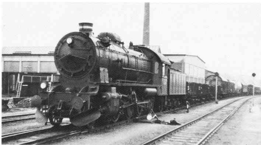
H 800, bygget af Borsig 1923, venter en oktoberdag i 1964 på afgang fra Fredericia. Denne maskine var et af de DSB-lokomotiver, som forsøgsvis blev forsynet med en hovedsagelig stålstøbt røgkammerdør, der blev spændt til ved hjælp af vridere langs randen i stedet for det sædvanlige arrangement med en centralt placeret bolt, travers og håndhjulsmøtrik. H 800, som først blev udrangeret 1976, er ikke hugget op; den tilhører Jernbanemuseet. Foto: Poul Thiesen.
