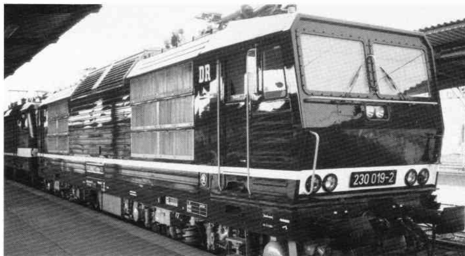
Tjekkisk bygget Skodalokomotiv, leveret april 1991. Indrettet til 2 strømsystemer for grænseoverskridende trafik i Østeuropa.
