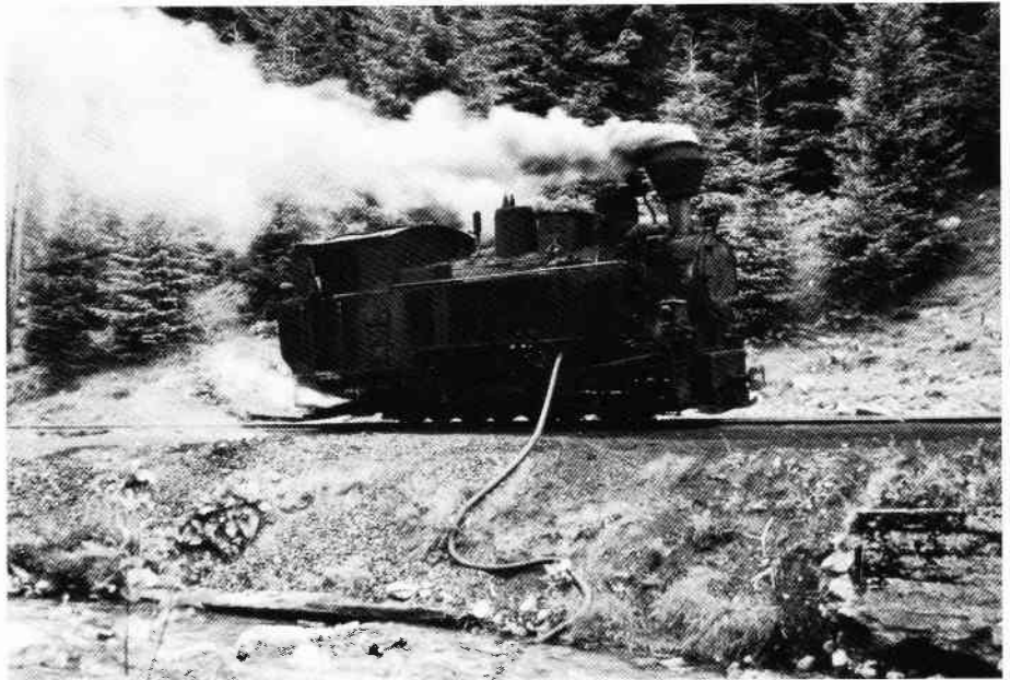
Oven for Coman tager DFF 764.452 vand fra elven med sugeslange. Slaggerne slukkes effektivt i vandet, 22/7 1991.
