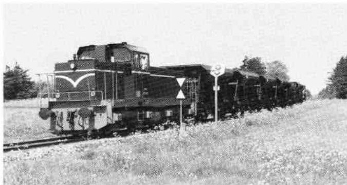
Den sidste ende af sporrenoveringen ved de danske privatbaner foregår lige nu på Hjørring-Hirtshals og på Nærumbanen. Til venstre trækker OHJ Kof 65 afsted med stoppemaskinen 63 og kørekran 61 fra Jægersborg til Nærumbanens værksted. Foto 22. juni 1992: Ole-Chr. M. Plum. Til højre skubber HP 16 syv DSB skærvevogne (Fcc og Fccs) forbi Erik Kjærsgaards kamera ved Horne. Skærverne skulle bruges ved sporrenovering ved udkørslen fra Hjørring og kom dertil fra et depot ved Tornby. Foto taget 23. maj 1992.
