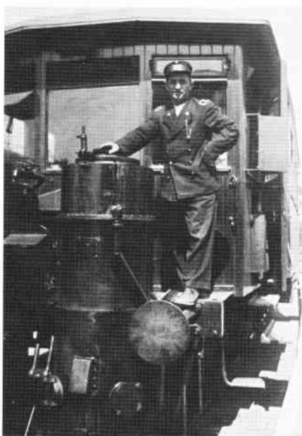
En af Lyngby-Nærum Jernbanes Triangel- motorvogne - 2. trækraft-generation på denne bane - udstyret med gasgenerator. Det er motorfører O. Holm, der poserer for fotografen.
