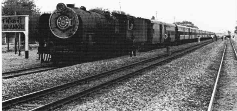
Metersporstog Jaipur-Agra fremført af YP-maskine på mellemstation. At vedligeholdelsesstandarden ikke altid er lige høj ses af førerhusets mistænkelige bagudhældning. (foto JP 1991)
