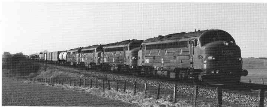
MY-lokomotiver danner grundlaget for DSBs beregninger om Løgstørbanen, der viser, at en fire-dobling af togantallet kræver en syv-dobling af togpersonalet. I dag kører godstogene normalt med MT, der - i modsætning til MY - IKKE har udstyr for multipelkobling. Her et eksempel fra 11. marts 1993 på, hvordan én lokomotivfører kan håndtere fire lokomotiver på én gang - 7275 HK, svarende til knap 15 gange den normale Løgstørbane-MT's kræfter. Foto af MY 1152, 1153, 1147 og MX 1012 nord for Glumsø: Allan Støvring-Nielsen.
