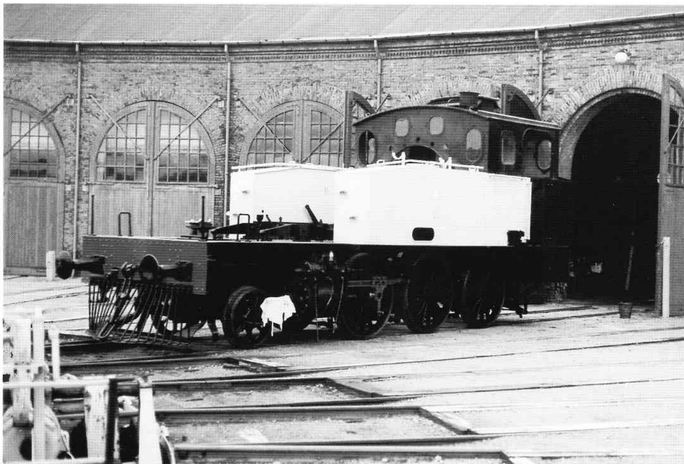
Find mindst 5 fejl! HV 3 med løst monterede siderandkasser og førerhus p.g.a. pladsproblemer. Foto: Ralph Hørberg.
