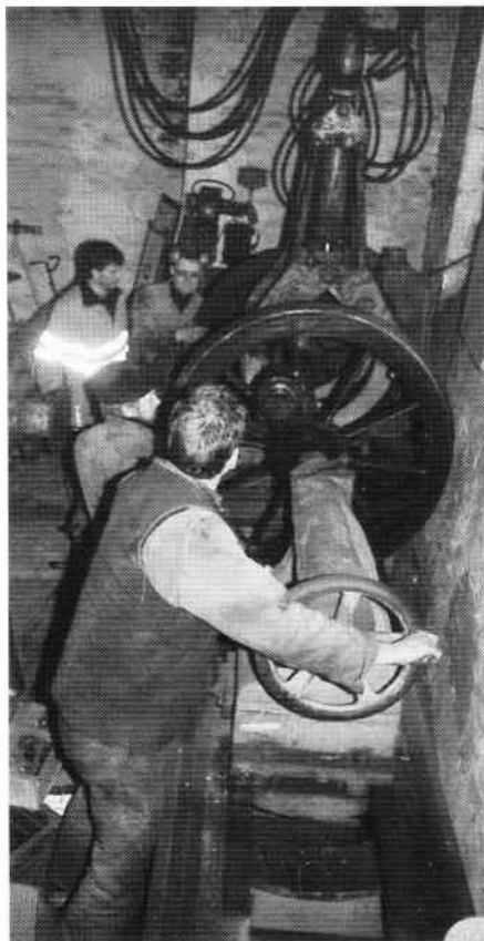
Nr. 19's ene hjulsæt på vej op i den store drejebænk med hjælp fra LJ's motortrolje. Forår 1995.
