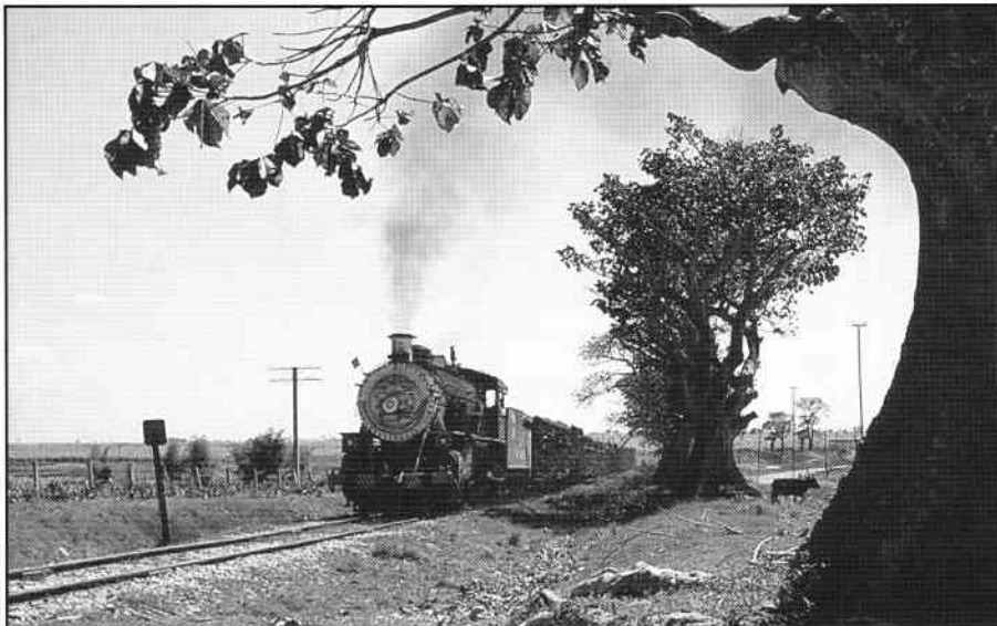
Cubas største damploko, det 1D1-koblede nr. 1910, bygget af ALCO i 1925, er her på vej med et tungt lastet tog til central 440. Toget har netop forladt statsbanestrækningen, der går på tværs lidt bagude, og mangler nu kun et par km ind til fabrikken. Uden for billedet er en ophidset sukkerfabriks-ansat i færd med at jage en busfuld engelske jernbaneentusiaster på flugt!
