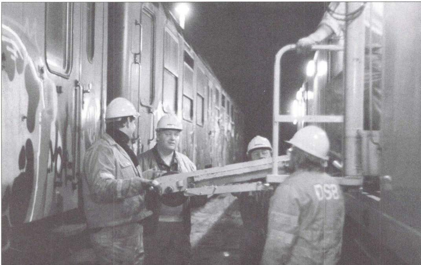
Hjælpevognsholdet er et sammentømret sjak, hvor man løfter i flok... Her er det »rulleskøjterne« til den syge BDN-vogn, der løftes ud fra hjælpevognen på øvelsesnatten i oktober (Bent Jacobsen).
