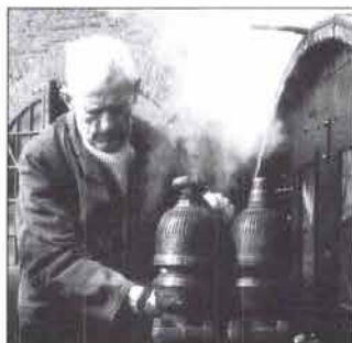
Tikjøb justerer sikkerhedsventiler på VLTJ 7, 1984 (Ole Lund Jensen)
