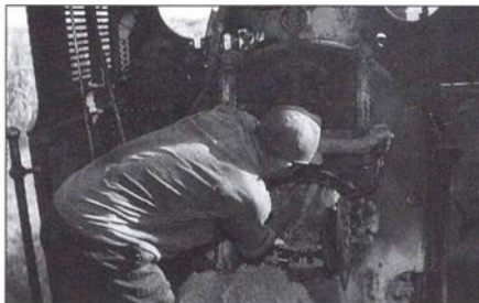
Indfyring af bagasse på nr. 18 fra PG Sragi. Som det fremgår, er en fyr-skovl ikke nødvendig, idet bagassen brækkes i stykker og herefter lægges i fyret med de bare hænder! 11. august 1995.
