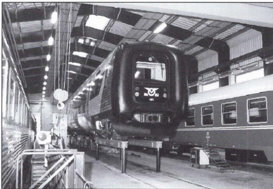
Efter moderniseringen af den store remise- og værkstedshal i Holbæk i 1996 har man ved OHJ og HTJ's fælleværksted fået mulighed for at løfte et helt IC2-tog f.eks. ved eftersyn m.m. Ovenfor ses OHJ-HTJ MF 1021-FS 1121 under et eftersyn 3. december 1997.
