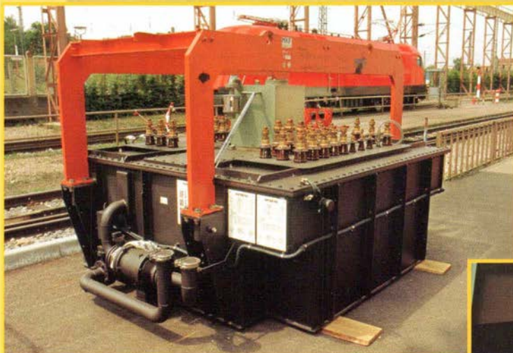
Hovedtransformer til EG 3103 klar til montage.
