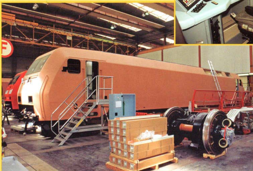
EG 3104. EG-lokomotivet vil med sin længde på 20,95 meter være et af de længste lokomotiver i Europa.
