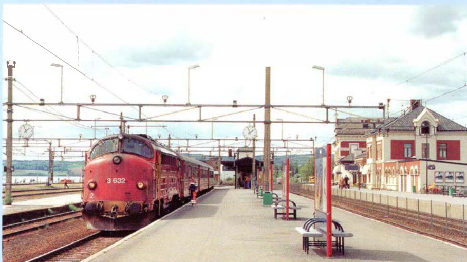
Di.3 632 hviler ud på Hamar station før det lange returløb til Trondheim, den 15. maj 1999. Størsteparten af Di.3 lokomotiverne er ikke renoveret i ende 2 og har derfor stadig det karakteristiske gitter. Foto: Kenneth Dam
